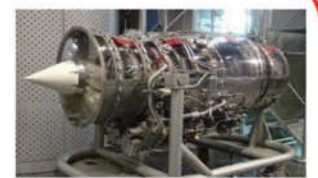
B F3-IHI-30 T-4練習機に使用されているエンジンです。構造や機能がわかるように一部スケルトン化して展示しています。
